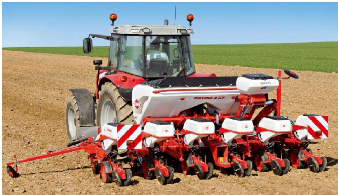
Σχήμα 11.3. Σπαρτική ανοιξιάτικων καλλιεργειών 6 γραμμών καθώς σπέρνει καλαμπόκι
