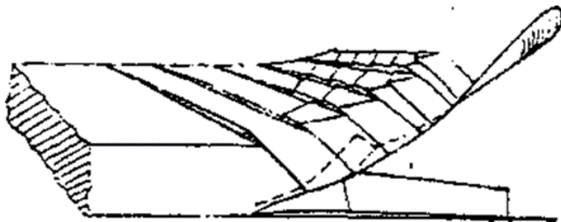
Σχήμα 9.2. Αναστροφή και θρυμματισμός του εδάφους από τον αναστρεπτήρα.
