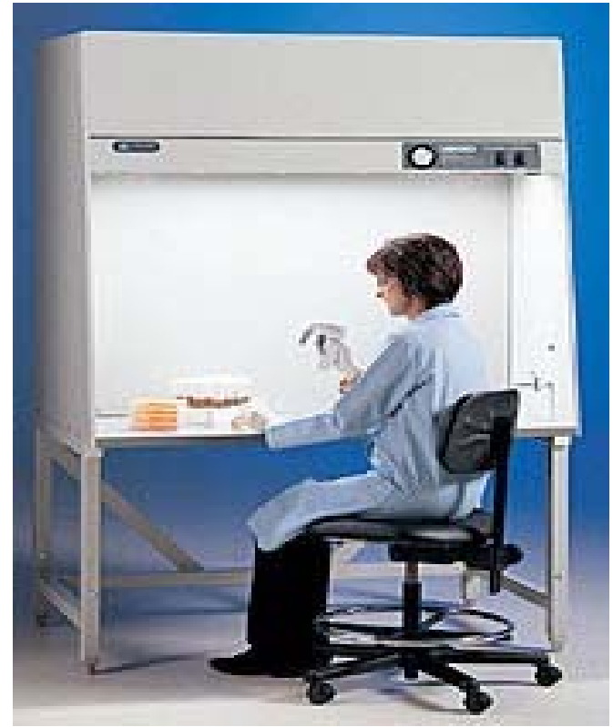
Εικόνα 6.4 (α) Θάλαμος νηματικής ροής βιολογικής ασφάλειας. (β) Σχηματικό διάγραμμα όπου φαίνεται το πρότυπο ροής του αέρα.
