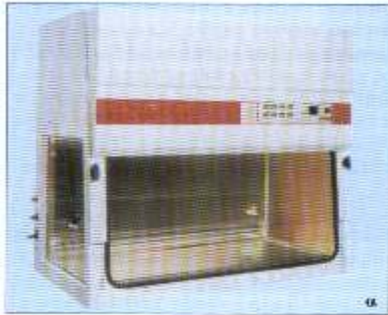
Εικόνα 6.4 (α) Θάλαμος νηματικής ροής βιολογικής ασφάλειας. (β) Σχηματικό διάγραμμα όπου φαίνεται το πρότυπο ροής του αέρα.
