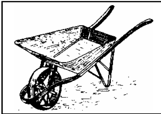
Σχήμα 6.3. Καροτσάκι για τη μέτρηση και τη μεταφορά της άμμου και των σκύρων.
